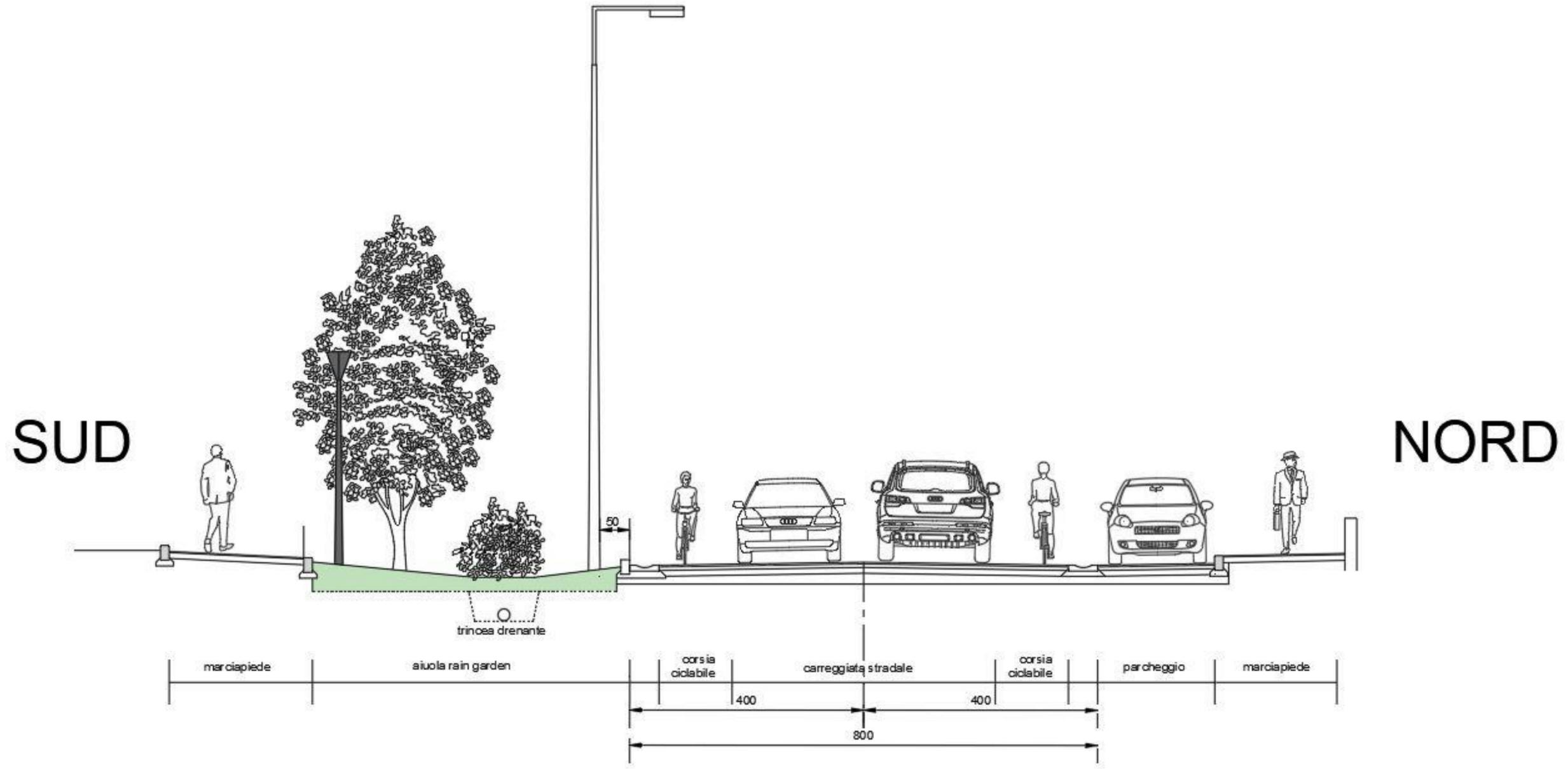
sezione stradale tipo di progetto
