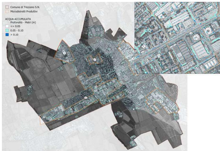
Fig. 4. Mappe dei pericoli climatici utilizzate durante gli incontri di co-progettazione: simulazione di evento di precipitazione intensa (60 mm/h in 15 min) - profondità dell'acqua accumulata (m) (fonte: elaborazione Laboratorio di Simulazione Urbana Fausto Curti).
